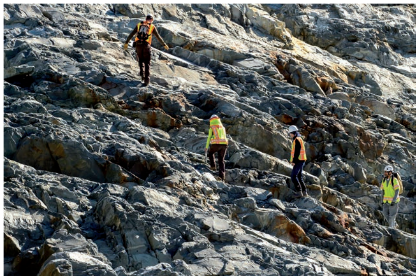
Abb. 7 Der Tag danach – Geologen beginnen ihre Untersuchungen; 28. 2. 2017. Die unebene, unregelmäßige Oberfläche des blaugrauen vulkanischen Gesteins zeugt von einer „absprengenden“, erosiven Wirkung. (Foto/Credit: Brian BAER/California Department of Water Resources)
