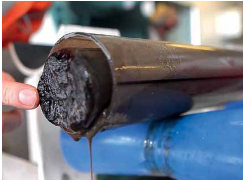
Abb.1 Kohlehaltiges Sediment. Bohrkern der IODP-Tiefseebohrung, Expedition 337, vom Kontinentalrand östlich Japan (Site C0020). (©Luc RIOLON, MARUM/IODP)
