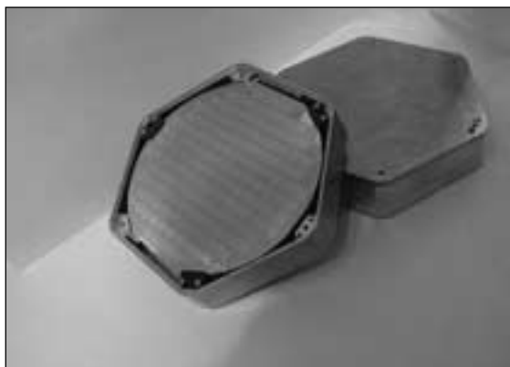
Abb. 1: Nahaufnahme eines verwendeten Detektors samt Einfassung. An der Oberfläche sind die aufgebrachten Schwingungssensoren erkennbar. ( http://cdms.berkeley.edu/public_pics/One_ZIP.html )
