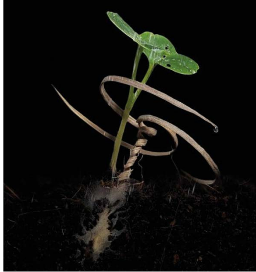
Abb. 6 Künstliche Selbst-einbohr-Einrichtung mit ausgekeimtem Samen, von der Forschergruppe um Luo (2023) entwickelt und hergestellt. (Foto: Carnegie Mellon University, mit freundlicher Genehmigung von Lining Yao)
