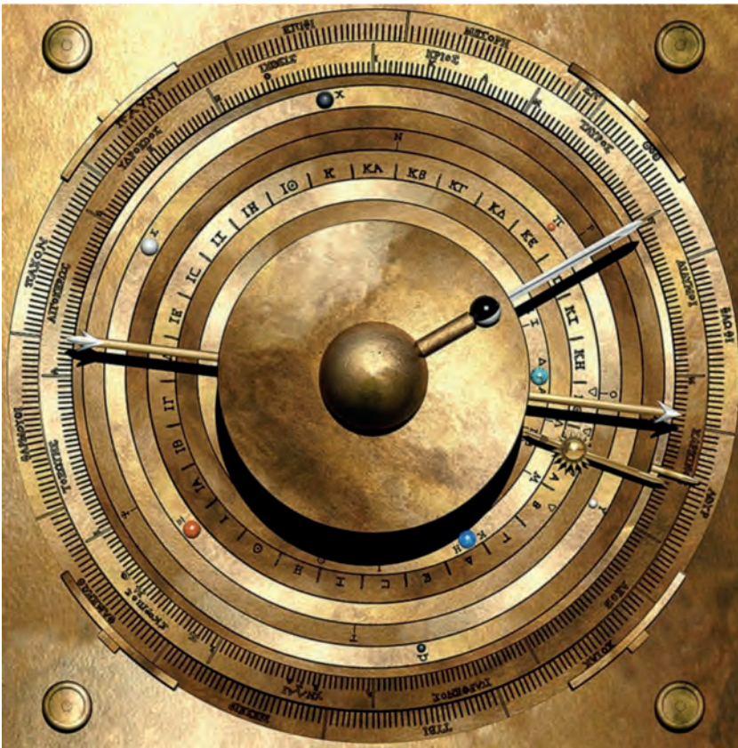
Abb. 2 Ein Computermodell der Vorderseite des Mechanismus von Antikythera: Die Erde ist in der Mitte, außen herum wird die Mondphase sowie ihre Position im Tierkreis dargestellt. Dann folgen Ringe für die inneren Planeten Merkur und Venus, für die Sonne (konkret „true Sun“, d. h. die Bewegung der Sonne inkl. der geringen Abweichungen der Kreisbewegung; vgl. S. 2) sowie für die äußeren Planeten Mars, Jupiter und Saturn. Eingraviert auf den Planetenringen finden sich Skalenmarkierungen und Indexbuchstaben für die synodischen Planeten-Zyklen (Synodische Periode = Zeit bis zur selben Stellung am Firmament zu Erde und Sonne). Außen herum sind Tierkreiszeichen und der ägyptische Kalender angeordnet, auf die ein Datumszeiger zeigt. Kopf und Schwanz der „Drachenhand“ zeigen auf- bzw. absteigende Mondknoten. Es sind auch Grenzen der Sonnen- bzw. Mondfinsternisse ablesbar. (FREETH et al. 2021, Fig. 7, CC BY 4.0, http://creativecommons.org/licenses/by/4.0/ )
